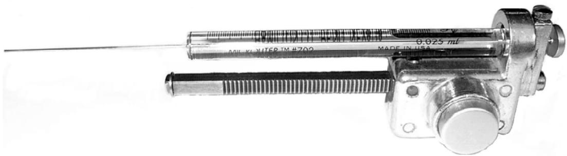
図2 ハミルトン製ディスペンザー
