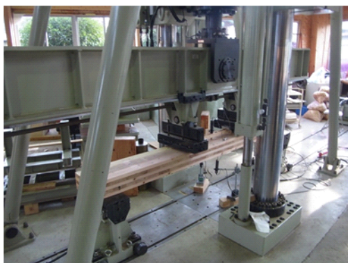
CLTパネルの曲げ試験
