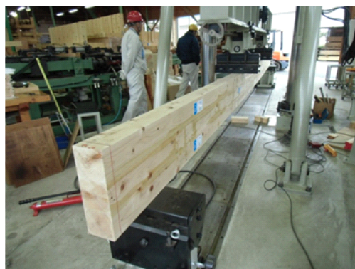
ヒノキ重ね梁の曲げ試験
