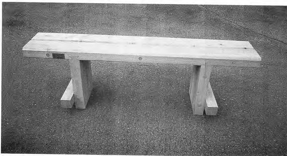
写真4 キシラデコールで塗装したベンチ
