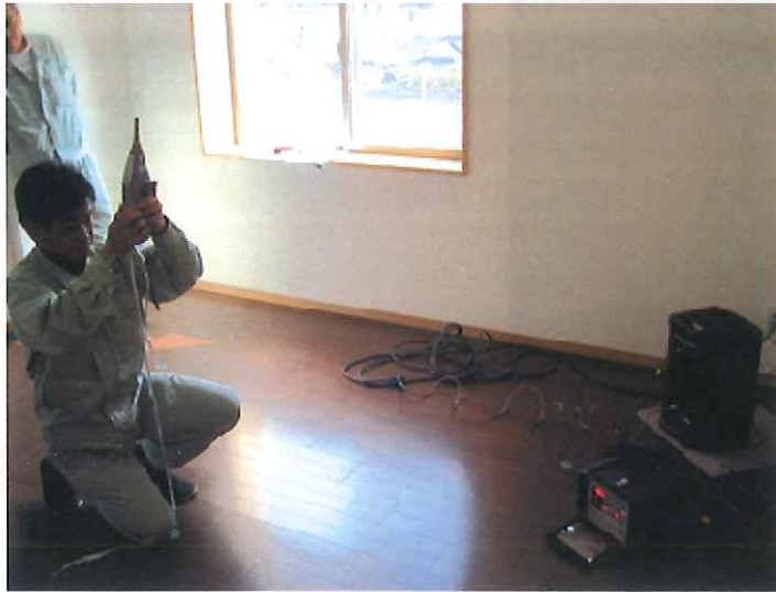
写真7 洋室2(音源側)測定
