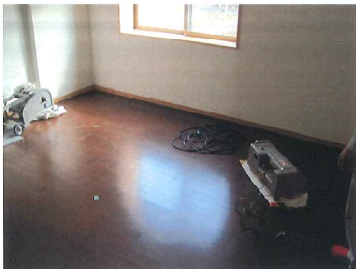
写真4 洋室2(音源側) 標準軽量床衝撃源(タッピングマシン)
