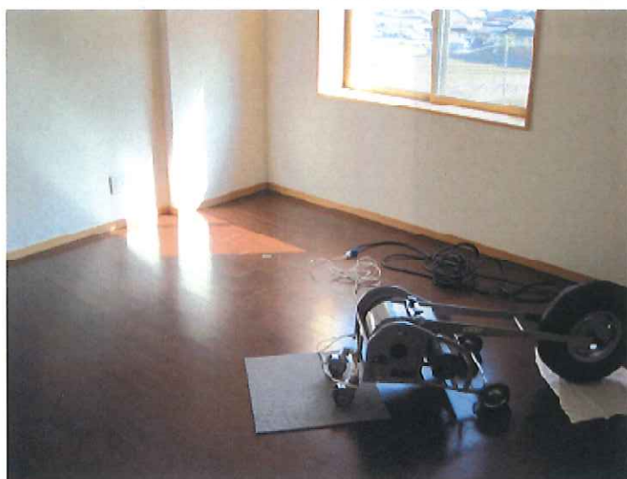
写真5 洋室2(音源側) 標準重量床衝撃源(ハンゲマシン)
