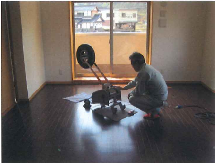
写真2 リビング(音源側) 標準重量床衝撃源(バングマシン)
