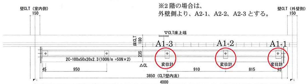
図 2.5 変位計番号 (真庭木材事業協同組合 CLT 共同住宅：A棟)
