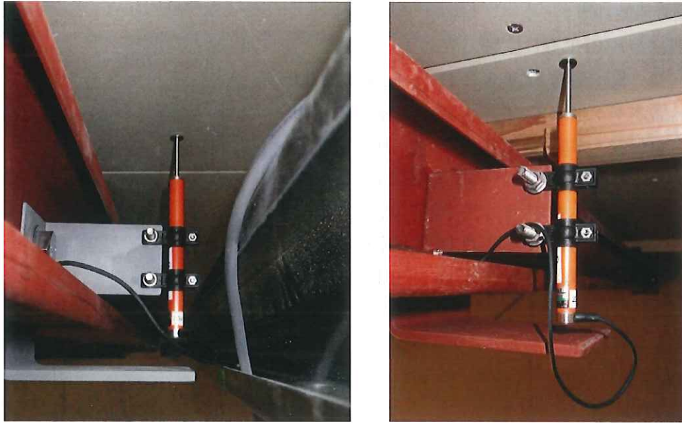
写真 2-2 CDP-25MT および設置風景
