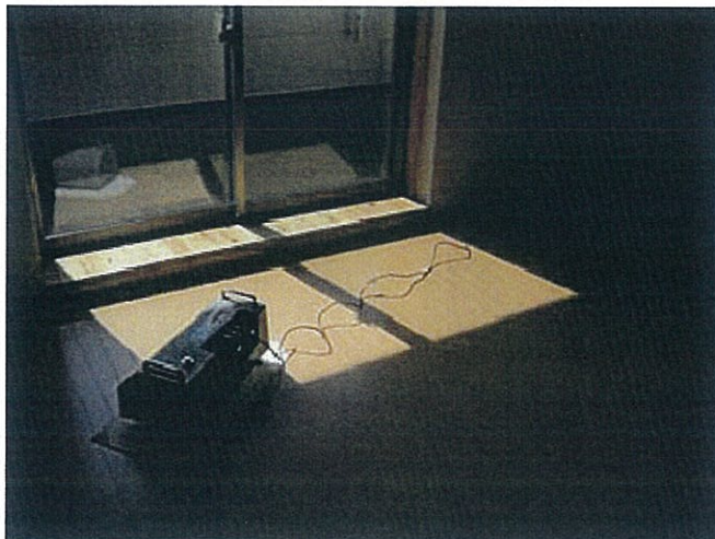
写真5 202号洋室(音源側) 標準重量床衝撃源(バングマシン)
