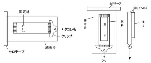
粘着力試験法の第2法では、図示した粘着力試験器で約3~5cmの速度で引張ることはできない。図示した粘着力試験器と同じ条件とした試験器を用いて粘着力を測定すること。
