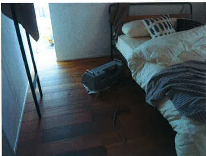
写真3 2F 洋室(音源側)竣工後 標準軽量床衝撃源(タッピングマシン)
