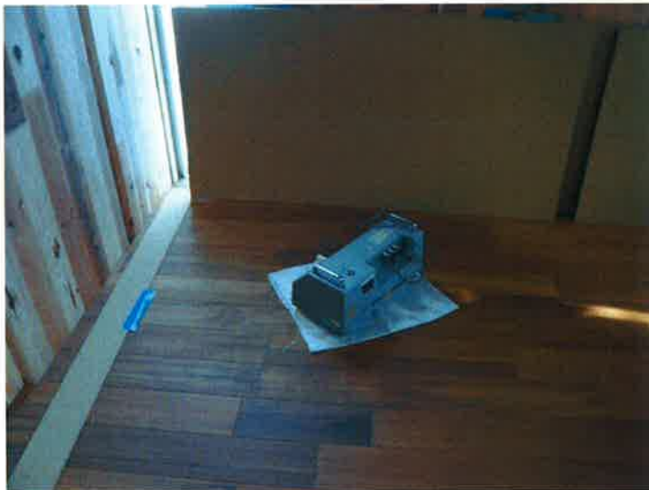
写真 2 2F 洋室(音源側)床仕上げ後 標準軽量床衝撃源(タッピングマシン)
