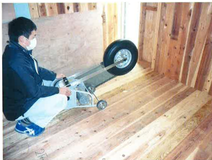
写真4 2F 洋室(音源側)床仕上げ前 標準重量床衝撃源(バングマシン)
