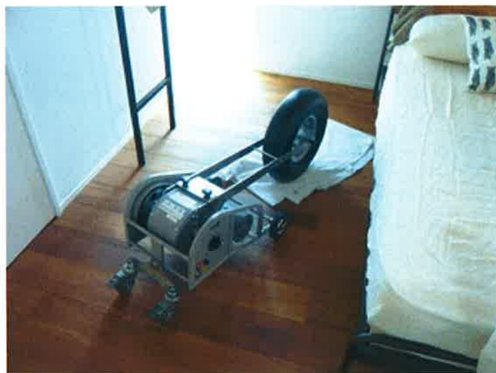
写真 6 2F 洋室(音源側)竣工後 標準重量床衝撃源(バングマシン)
