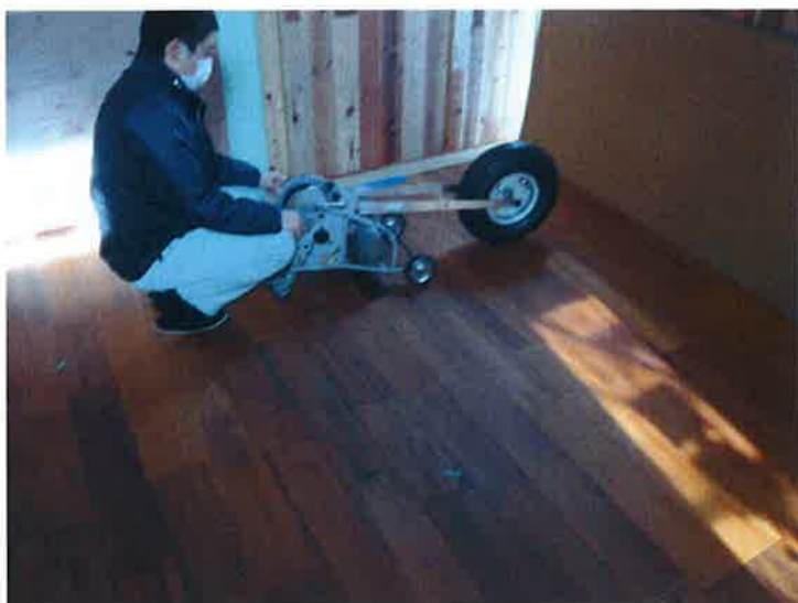
写真 5 2F 洋室(音源側)床仕上げ後 標準重量床衝撃源(バングマシン)
