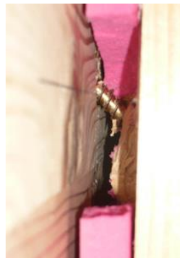
写真 2-3 試験体 4 におけるビスの曲げ変形
