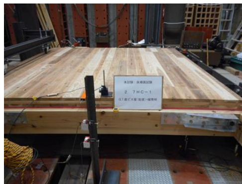
写真3-1 床水平構面の面内せん断試験
