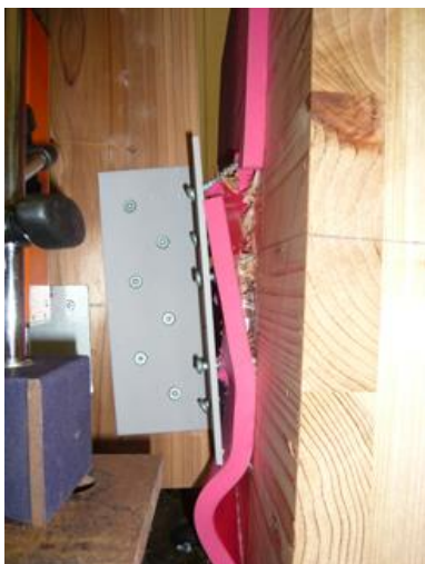
写真 2-2 試験体 3 の破壊状況
