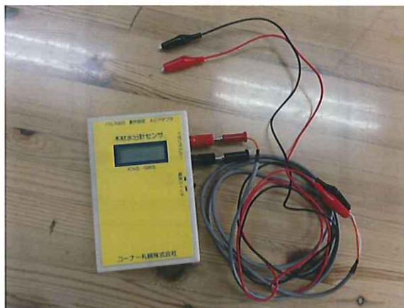
写真 2.3 木材水分計センサ（KNS-GWS）
