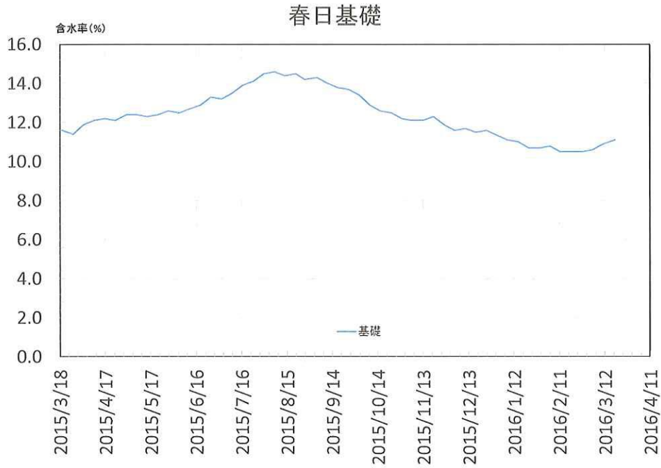
図 3.10 春日基礎の含水率
