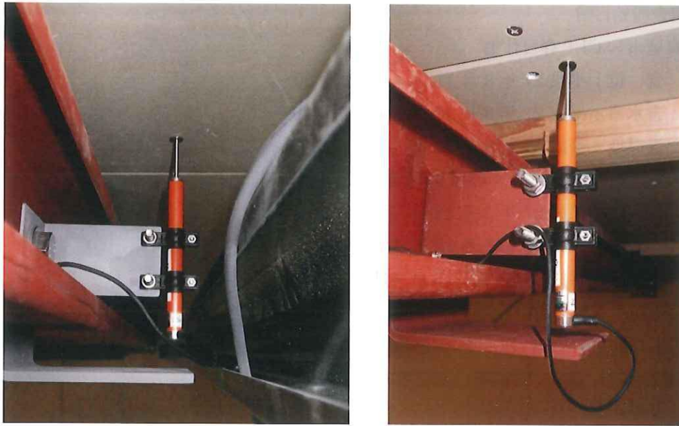
写真 2-2 CDP-25MT および設置風景
