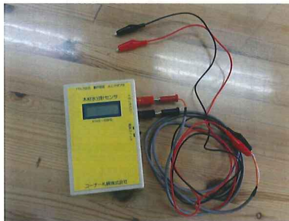
写真 2.3 木材水分計センサ（KNS-GWS）
