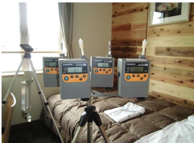
2階 236号室 客室(シングル) (採取ポンプとサンプラー)
