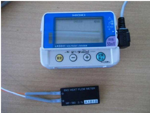
写真-6 熱流計・データロガー
