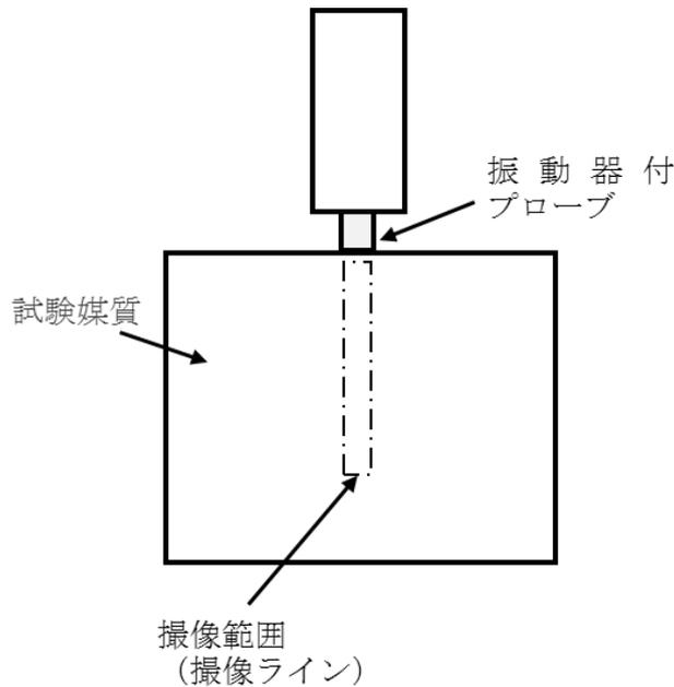
図5 伝搬速度、弾性率計測の模式図(例)
