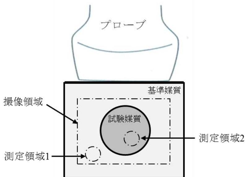
図1 ひずみ比計測の模式図（例）
