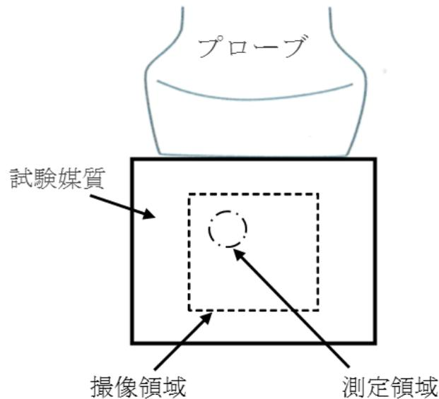
図4 伝搬速度、弾性率計測の模式図(例)
