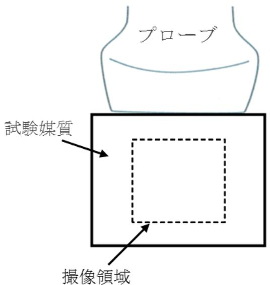
図2 伝搬速度、弾性率計測の模式図(例)
