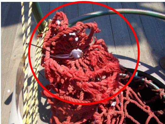
破れたネット
