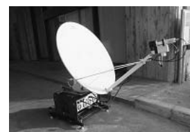
(衛星回線接続用アンテナ)
