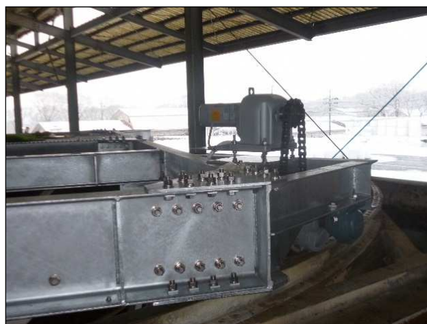
大きな負荷がかかる攪拌部をステンレス鋼で補強 錆びやすいボルト・ナット類もステンレス製に更新
