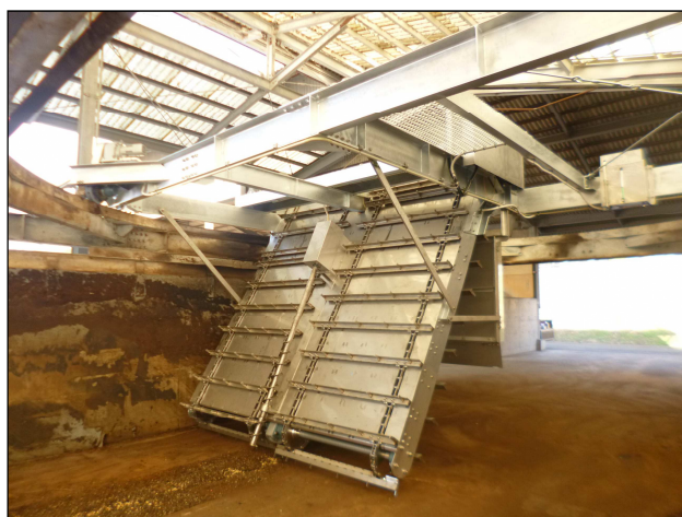
大きな負荷がかかる攪拌部をステンレス鋼で補強 錆びやすいボルト・ナット類もステンレス製に更新
