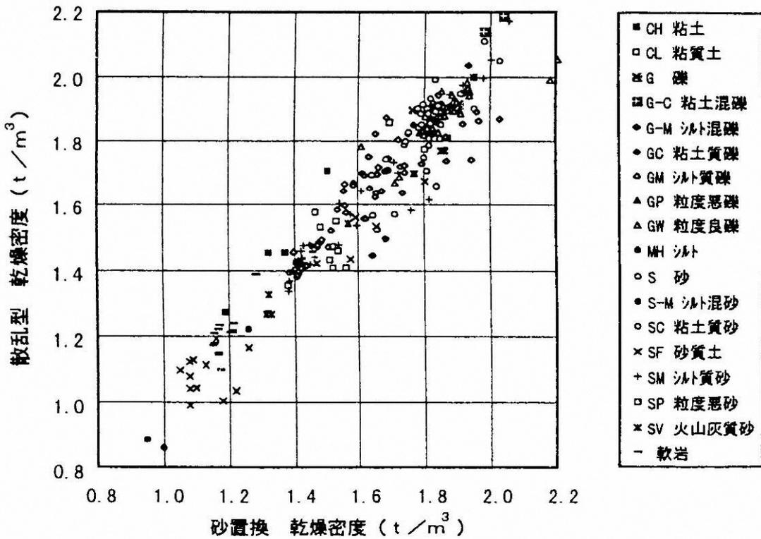
図一 砂置換と散乱型の相関 (乾燥密度・土質別データ)
