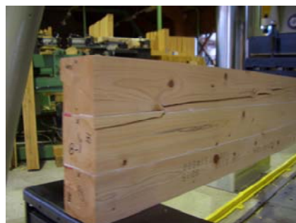
ヒノキ重ね梁の曲げ試験（梁として適さない材を使用した例）
