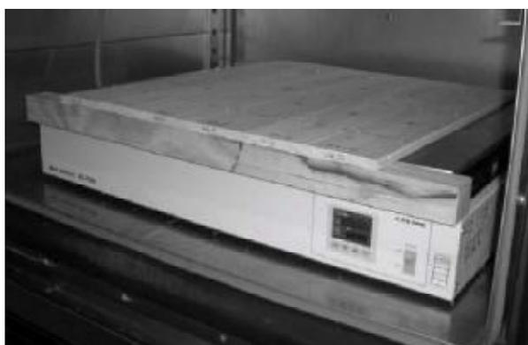
第1図 小型床暖房フローリングユニットの概要
