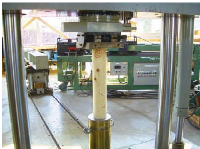
写真1 圧縮試験の状況
