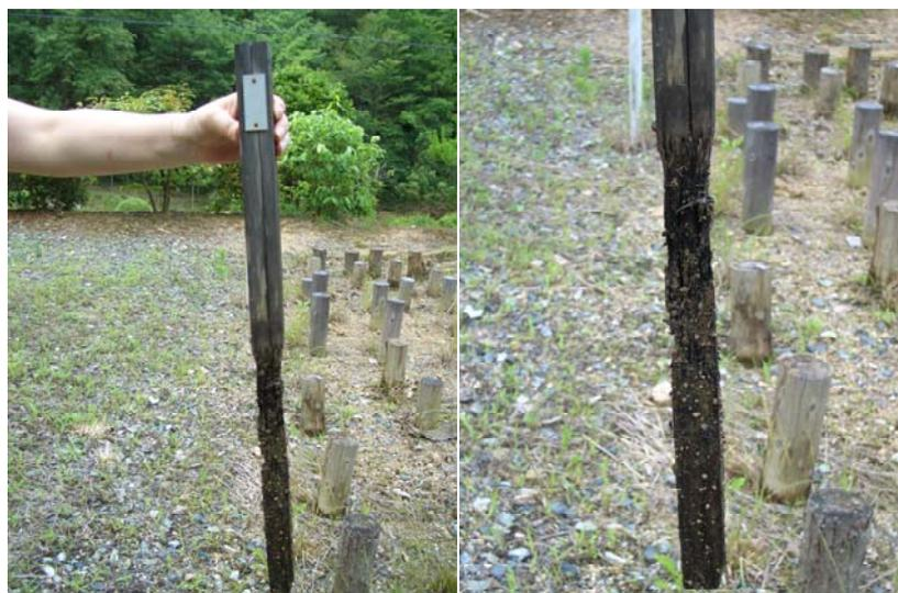
写真2 軟腐朽菌による杭の被害状況
