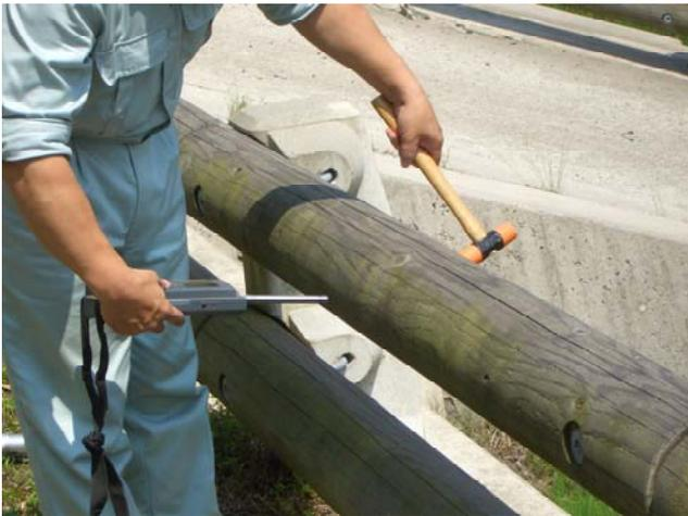
写真2 たわみ振動による固有振動数の測定
