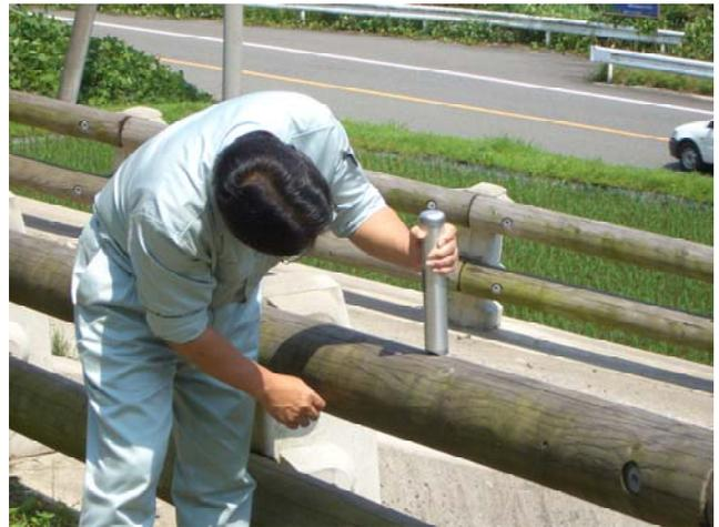
写真3 ピロディンによる測定状況
