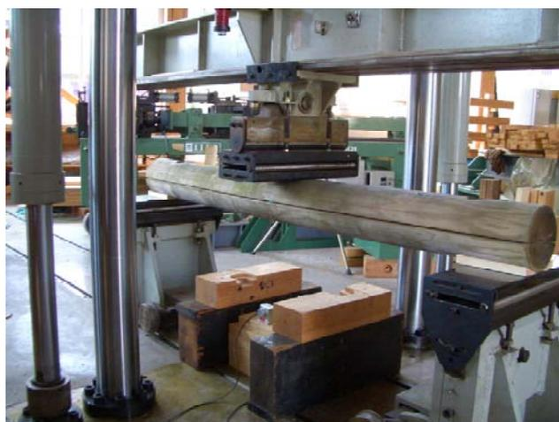
写真4 静的曲げ試験の状況
