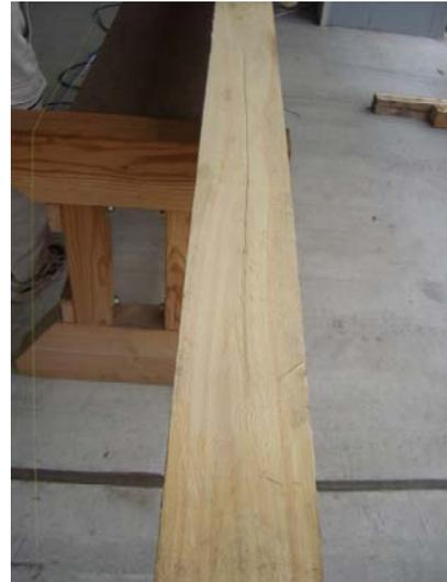
写真 13 発生した材面割れ
