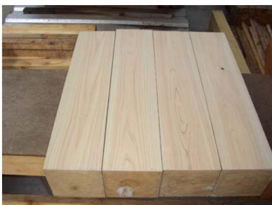
写真10 乾燥後の材色（鉋削後）
