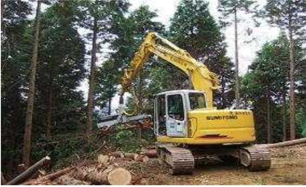
図-8 ハーベスタによる造材作業
