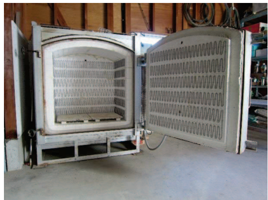
干支の置物を焼いた電気窯内部
