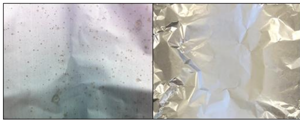
図2 異なる重合度のPVA溶液を用いて作製した試料の外観写真 (左：重合度500、右：重合度2000)
