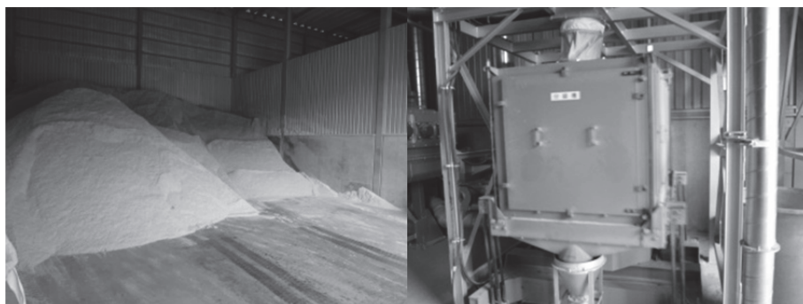
図4 製材所より収集したおが屑(写真左)と乾式振動ふるい機(写真右)
