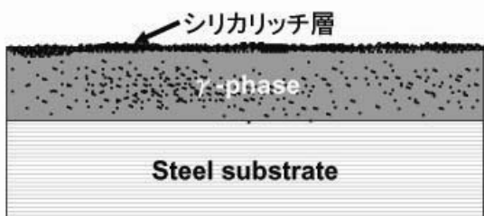
図4 Zn-Ni-シリカ複合めっき皮膜の断面構造
