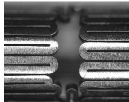
図10 改良した切断パスによるリンク近傍
