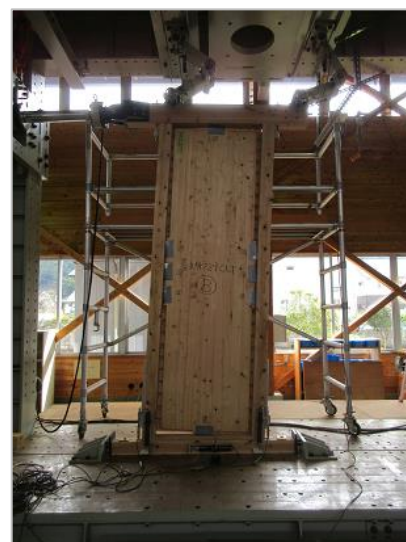
耐力壁の面内せん断試験
