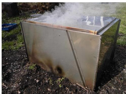
斜煙道式炭化炉
