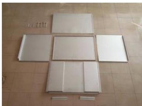
簡易軽量炭化炉（分解）
