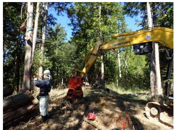
ウインチを利用した簡易架線集材
