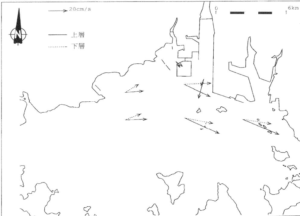
图 5-2-14(2) 最大大潮期流況図 (下げ潮最強時)
