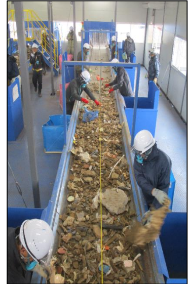
中間処理施設による処理状況（二次選別処理施設での手選別ライン）
