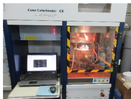
図5 コーンカロリーメーターによるヤギの発熱量の測定
