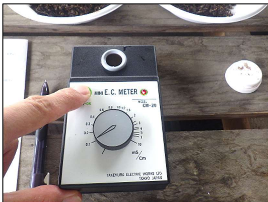
図-5-4 ECメーターの利用例 簡易肥料濃度計 CM-20 (竹村電機製作所製)
