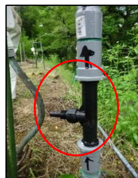
図-9-3 ナノバブル装置の設置
