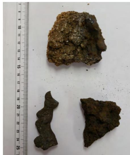
写真5 炉壁（上）鉄滓（下）
