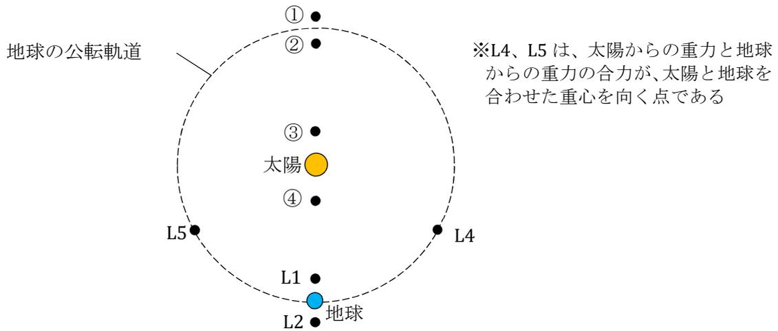
図6 太陽-地球ラグランジュ点（模式図）
