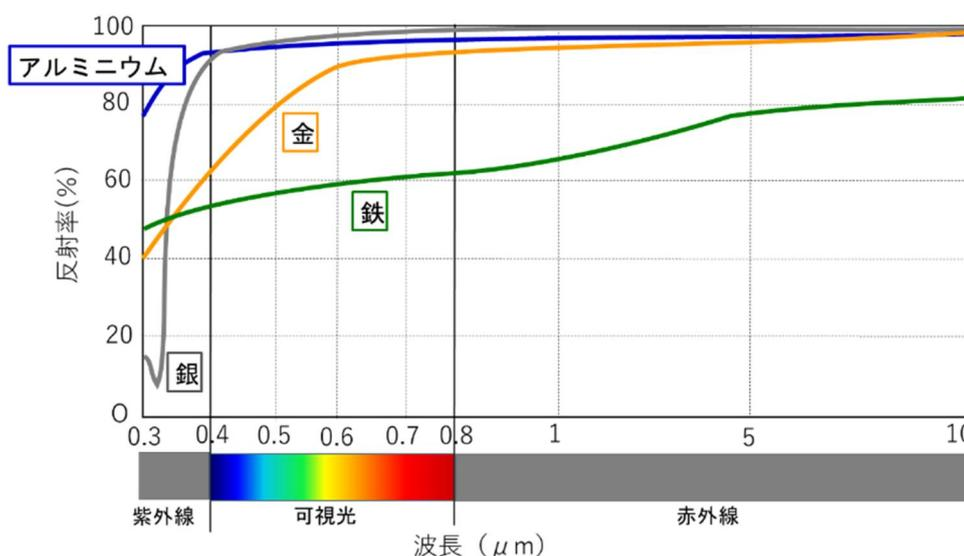
図5 主な金属の反射率
