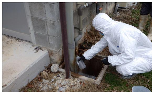
上図：浄化処理施設から採取した水を分析し、処理能力向上を図る様子
