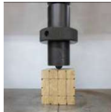
図3 表面硬さ試験の状況
