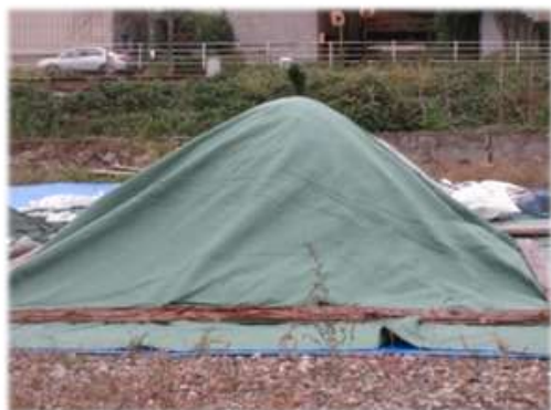
図5 木質バイオマス乾燥・保管シート被覆による実証試験
