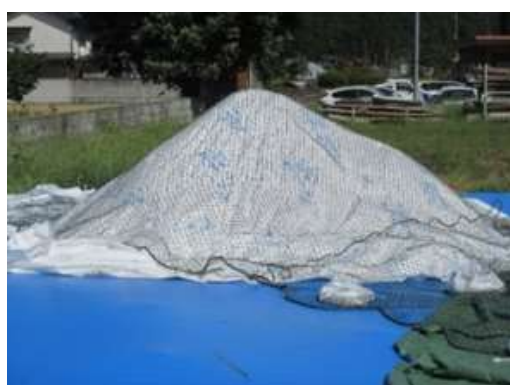
図7 防水透湿シート被覆による実証試験
