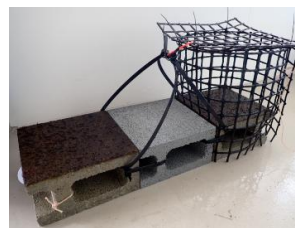
写真1 アカモクを着生させた基質 （右側のブロックには食害の有無を確認するためネットを装着している）
