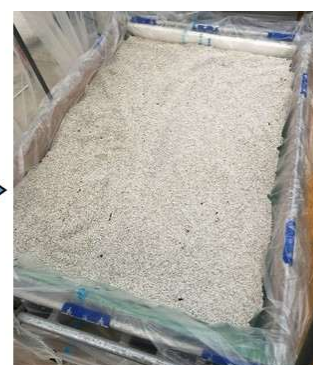
ビニールを敷いて パーライトを敷き詰める
