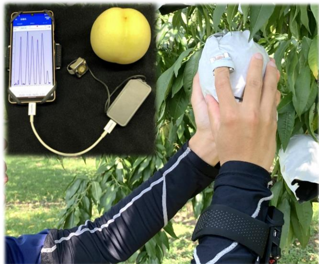
図1 果実硬度共鳴測定器「ゆびけん」 (生物振動研究所製)と測定の様子
