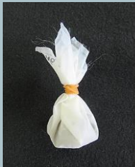
図1 10gの風乾土を包んだナイロンメッシュ（左図） 流水中で土壌を洗い流す様子（右図）
