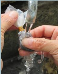
図1 10gの風乾土を包んだナイロンメッシュ（左図） 流水中で土壌を洗い流す様子（右図）
