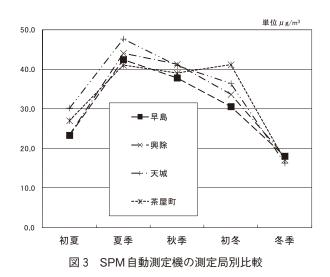
SPM自動測定機は粉じん濃度を1時間値として逐次捉えているのに対し、SPMマニュアル測定は23時間連続捕集後の結果であるため、夏季の高温の状況では、捕集ろ紙からの低沸点成分の再揮散等の影響が推察される。すなわちSPMローボリウムエアサンプラは、PM2.5ローボリウムエアサンプラのように、捕集ろ紙の部分が外気温と5℃以上差が生じない機構となっていないことが影響している可能性が考えられる。
