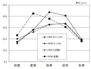
図2 PM2.5 及びSPMのマニュアル測定と自動測定機の質量濃度比較
