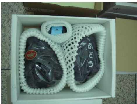
←衝撃振動計測器の設置
