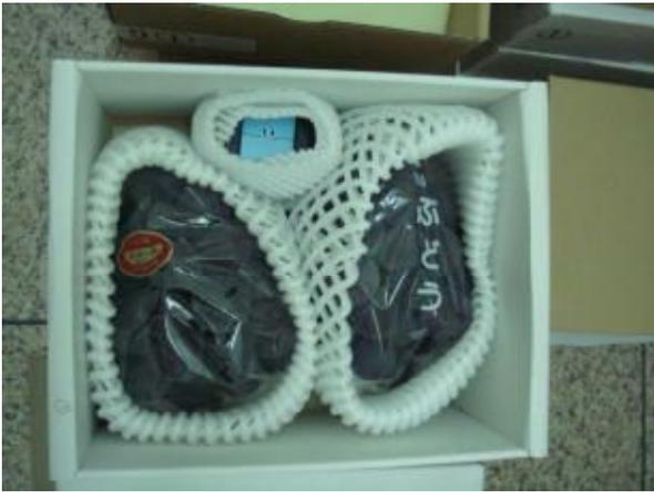
写真1 衝撃振動計測器設置
