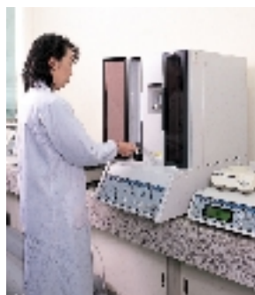
ラジウムを測定する アルファ線自動測定装置
