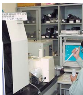
ウランを測定する 高周波誘導結合プラズマ質量分析装置 (ICP-MS)
