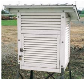
現地百葉箱(中にRPLD素子を設置している)
